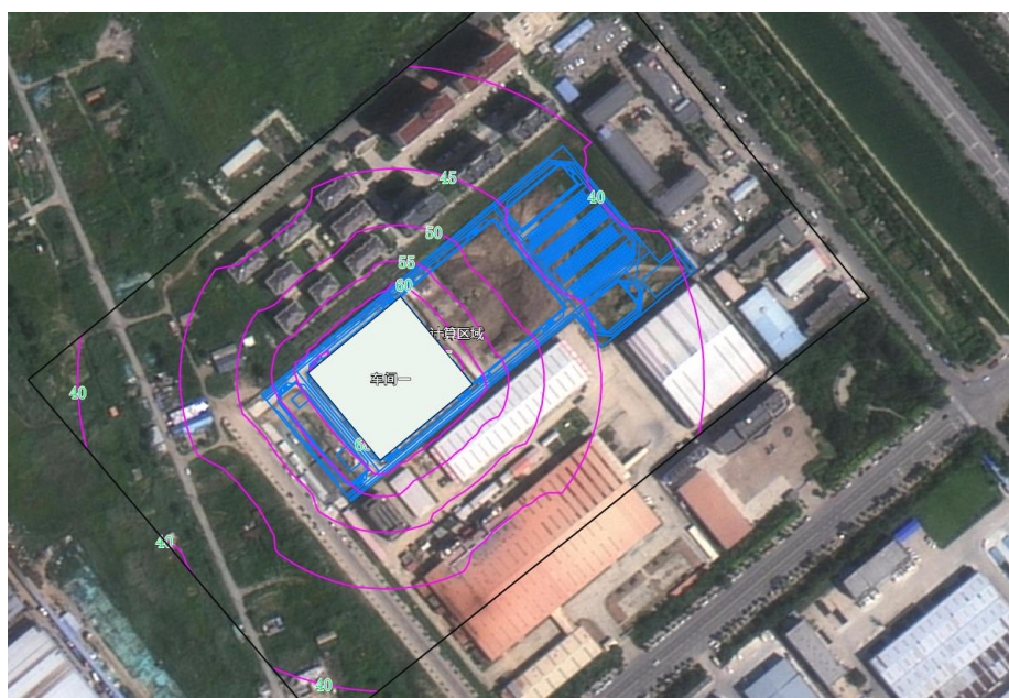
图 4-2 本项目建成后全厂噪声影响等声级线图
